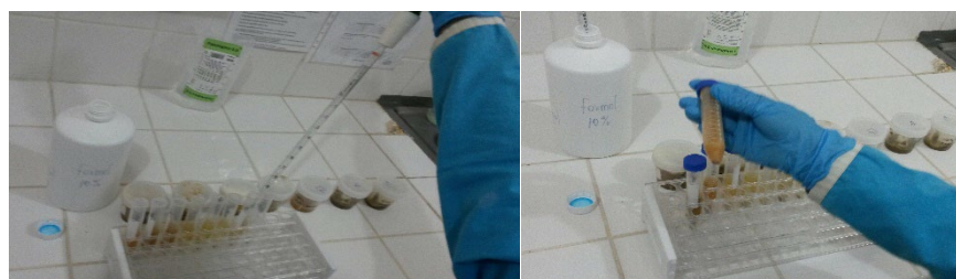
Figura 12: Agregación de formol al 10% y agitación de la muestra.
