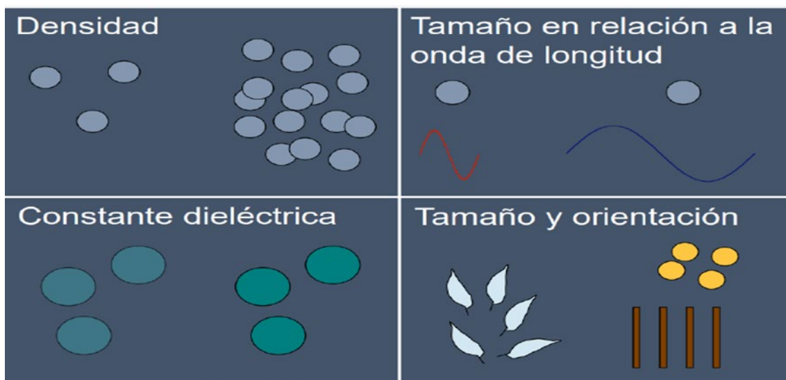
Figura 11: Características de la superficie relacionados a estructura
