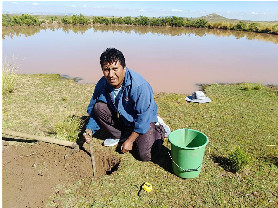
Fotografía 13. Excavación de hoyo para el cálculo de la permeabilidad del suelo.
