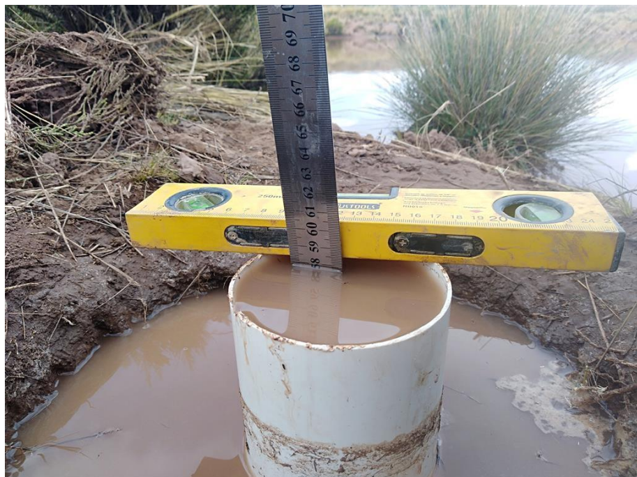
Fotografía 14. Registro del nivel de agua y tiempo, para el cálculo de la permeabilidad del suelo.
