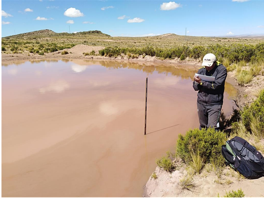
Fotografía 7: Registro de altura o nivel de agua en limnómetro.
