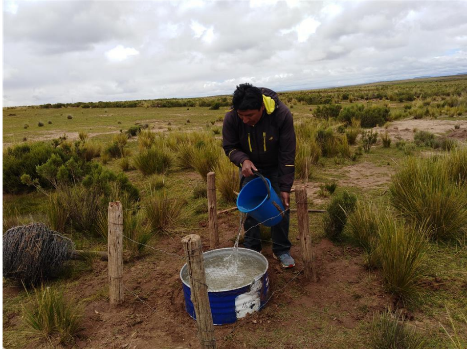
Fotografía 11. Recarga del nivel agua en tanque evaporímetro de Tipo A.
