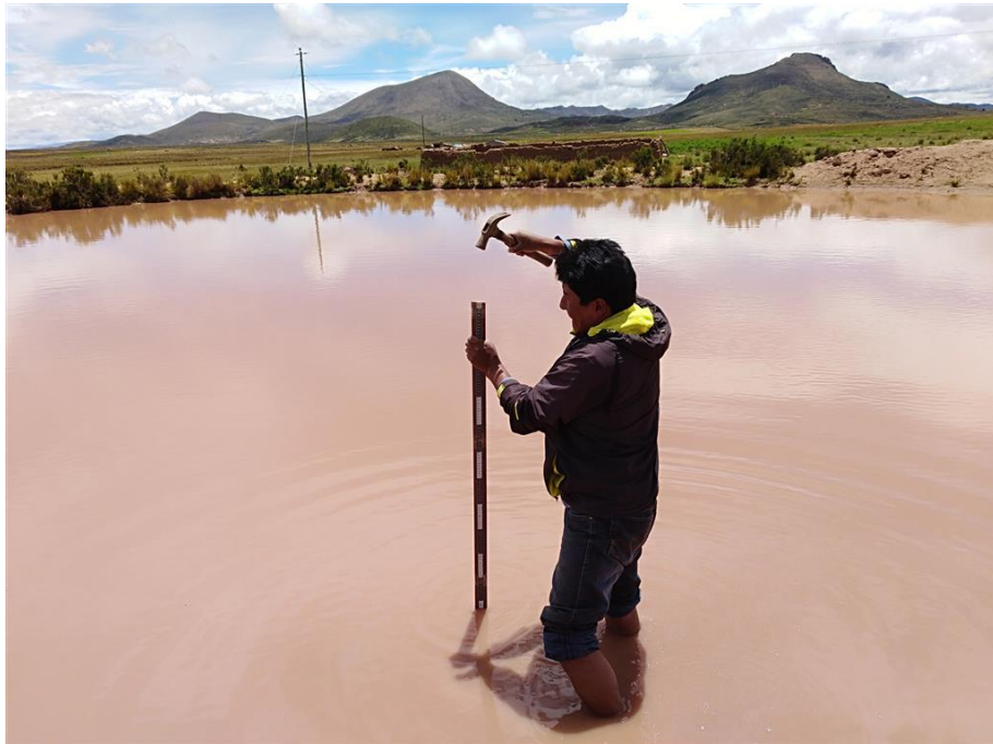
Fotografía 6. Instalación de la varilla de madera graduada de 150 cm (limnómetro).
