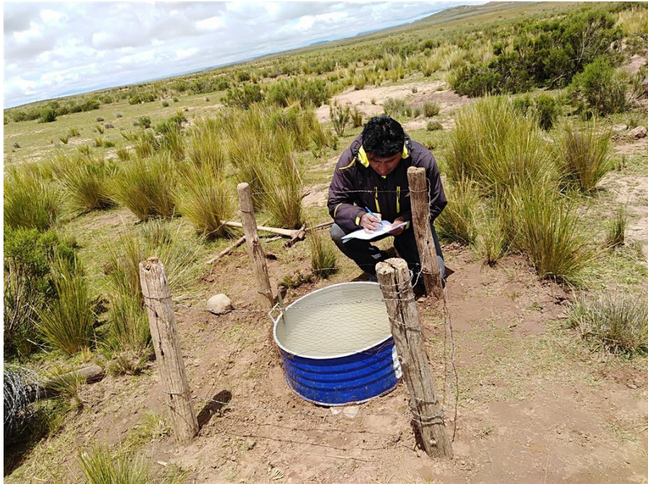
Fotografía 12. Registro del nivel de agua en tanque evaporímetro de Tipo A.
