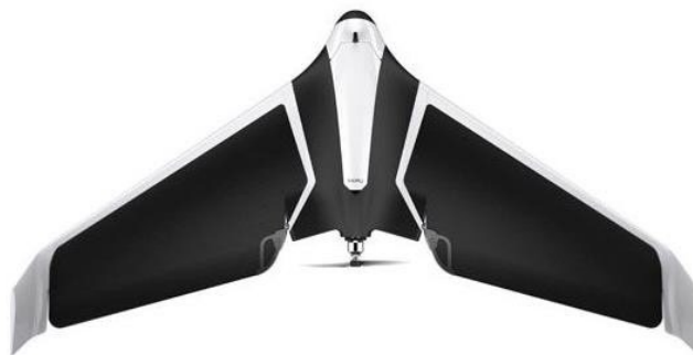
Imagen 5: Drone de ala fija
