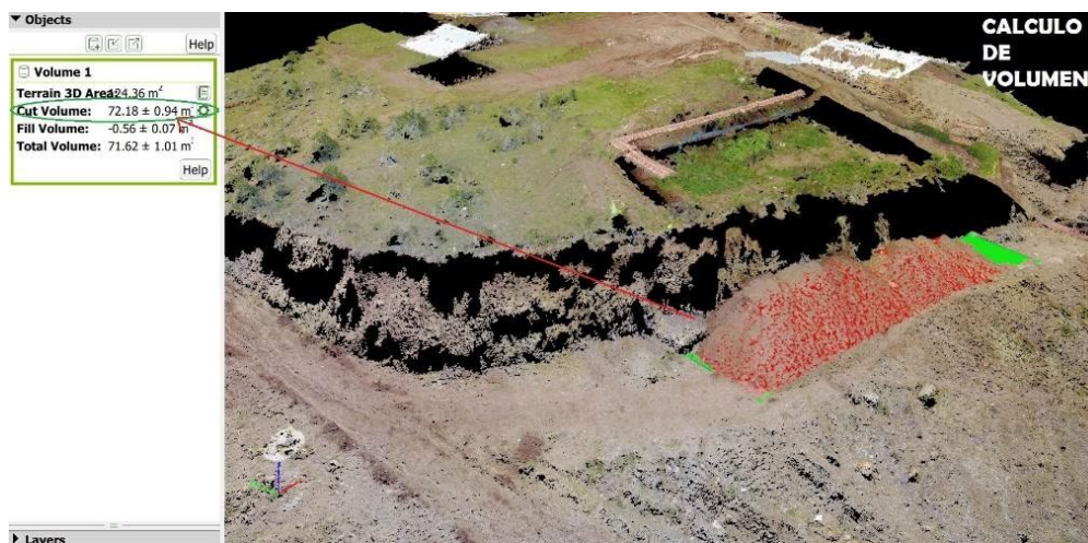
Imagen 12: Cálculo de volumen de corte con Pix4D Mapper
