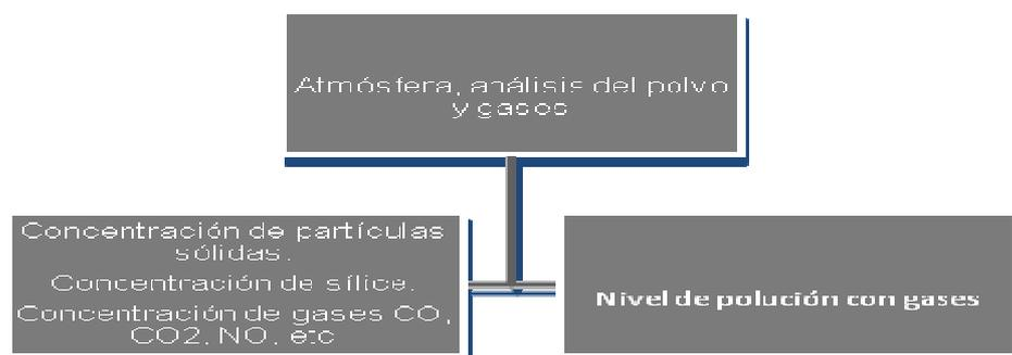
**Figura No 6** *Caracterización del aire en ambiente subterráneo*
