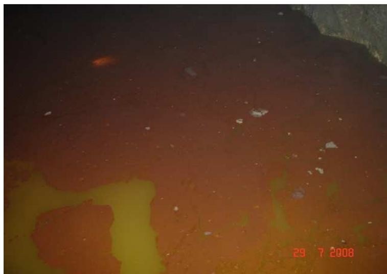
A parte de tener hidróxidos de hierro, se incrementa la acidez además que se tiene caudales grandes los cuales ya afectan el medio ambiente superficial donde se tiene un gasto enorme de cal en la planta de tratamiento. Por esta razón estos deben ser captados en lugares anegados donde se pueden ser tratados con cal en interior mina.
