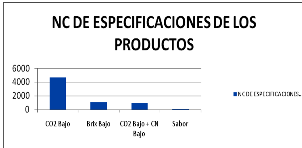
Gráfico N° 60: Diagrama Pareto que Representan el Porcentaje de Producto No Conforme según Especificaciones de Coca Cola 2000 MI Rp (2005-Oct. 2008)
