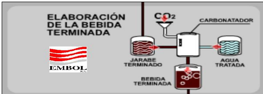
Grafico N° 13: Proceso de Elaboración de Bebida Terminada Embol S.A.
