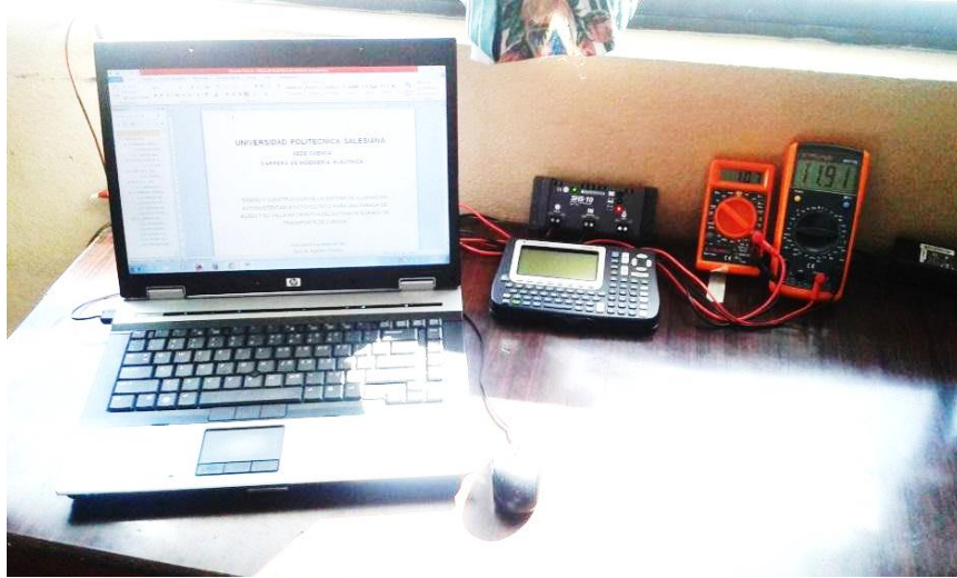
Figura 17. Medición de voltaje y corriente generado por el panel solar.
