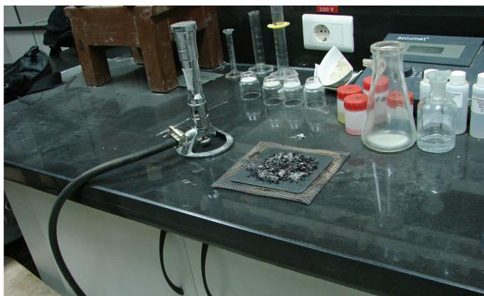
Figura 3.3: Pruebas de Combustión a 350 °C con Quemador Bunsen
