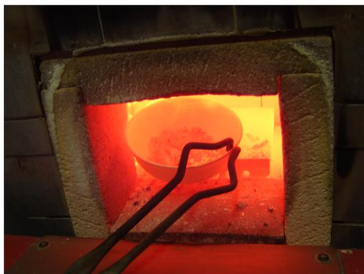
Figura 3.5: Pruebas de Combustión a 1500 °C con Horno de Inducción
