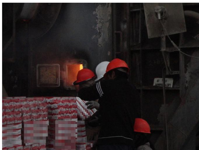
Figura 3.12: Ingreso de AFRs Cabezal de Salida
