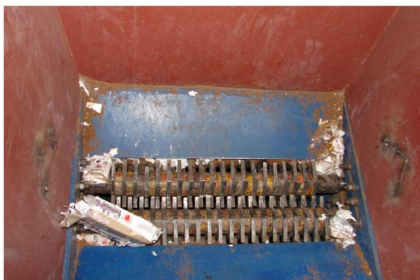
Figura 3.11: Cuchillas - Trituradora de Materiales Blandos
