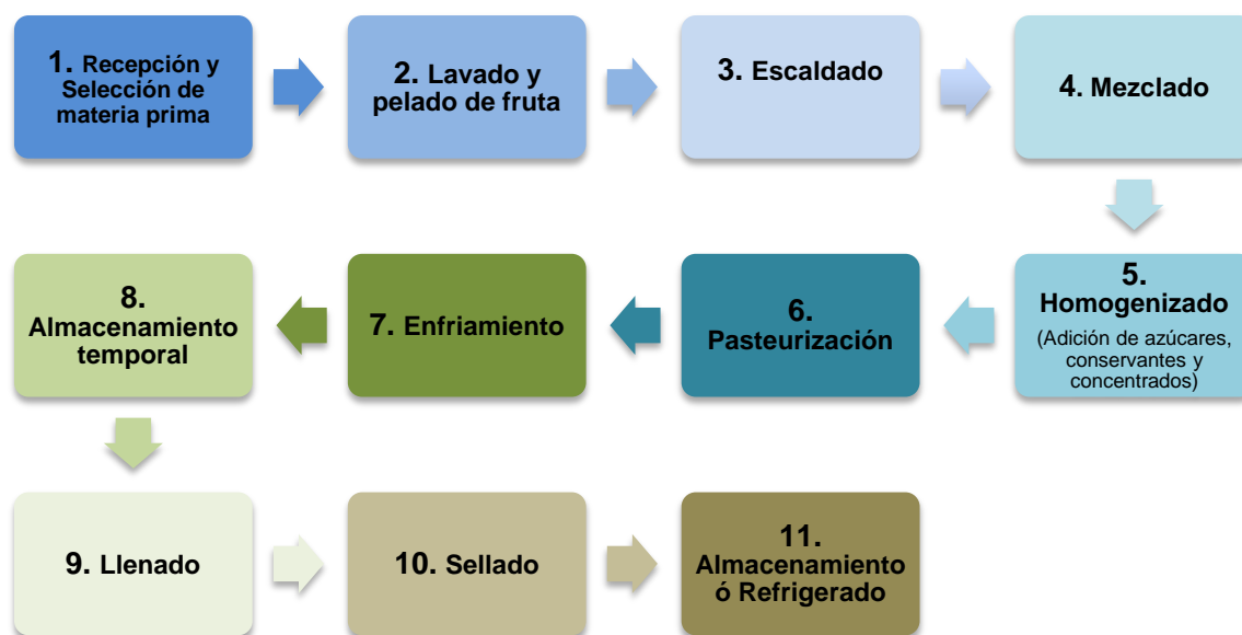
Figura Nº 17 Proceso de producción de los jugos de fruta
