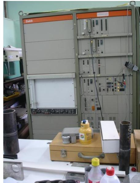
**Figura 15** Maquina universal de fuerzas ZWICK 1474, marca Amler 221, procedencia alemana, calibrada por el encargado del servicio
