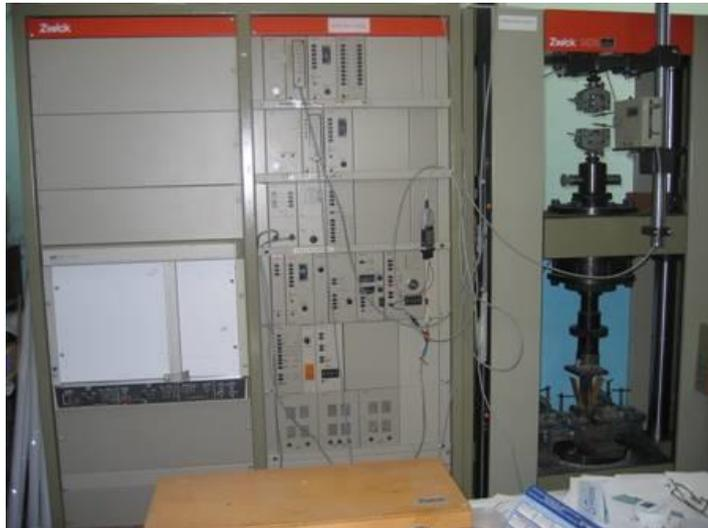
La potencia es proporcionada por un motor eléctrico que acciona un dispositivo mecánico de engranajes y tornillos sin fin, para transmitir
