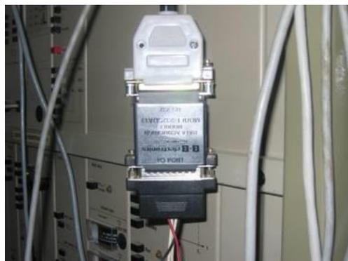
El CAD convierte las variaciones de milivolts analógicos en pulsos digitales que se reciben en un PC mediante un programa propio del DAC y se almacena en formato de texto, que posteriormente se procesa mediante un utilitario como el EXCEL de Wiondows MS.
