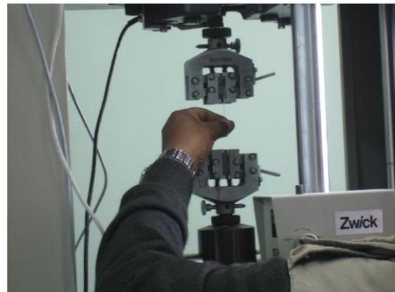
**Figura 16** Encargado del laboratorio de Física colocando las muestras en la maquina universal de fuerzas
