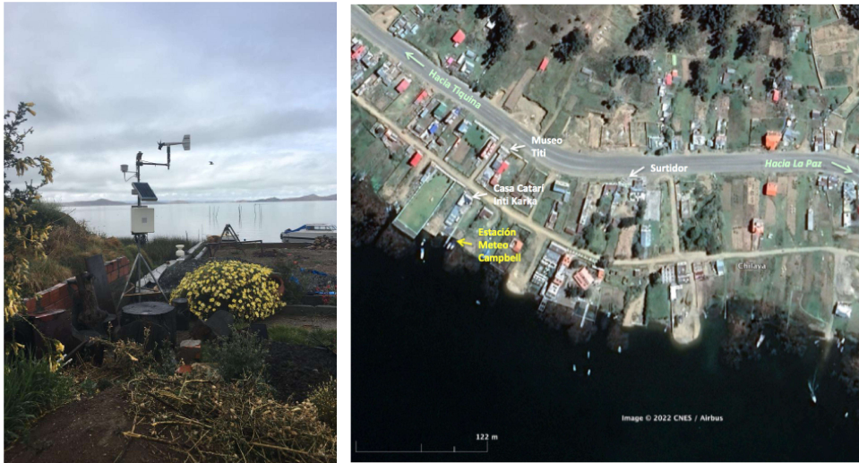
Figura 3-101 – izquierda: Estación meteorológica Campbell del IRD instalada en 2012, a orilla de Huatajata, a 4 km de la Boya HydroMet. Equipamientos: Datalogger Campbell CR1000, panel solar, anemómetro, higrómetro, quantámetro LiCOR, espectrofotómetro y pluviómetro. Derecha: Mapa del litoral de Huatajata con la ubicación de la estación meteo Campbell (en amarillo) en la propiedad de la familia Catari, cerca del Museo Titi de la navegación ancestral (a bordo de balsas de totora) y del surtidor.
