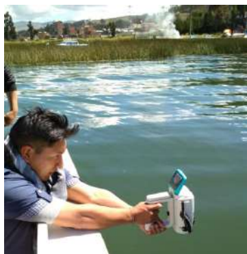
Figura 3-70 – Toma de muestras con espectroradiómetro HandHeld2 en el Lago Menor del Titicaca, Sector Huatajata. Fuente : Nuñez Villalba (2018).
