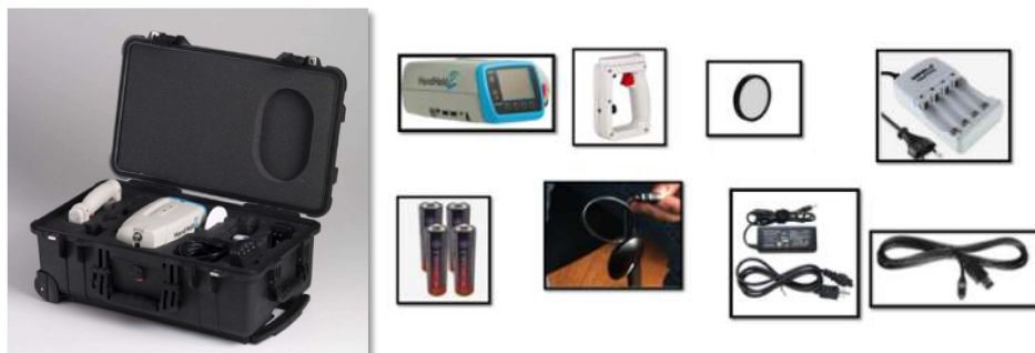
Figura 2-15 – Espectroradiómetro ASD FieldSpec HandHeld-2 con sus accesorios en su Pelicase de transporte.
