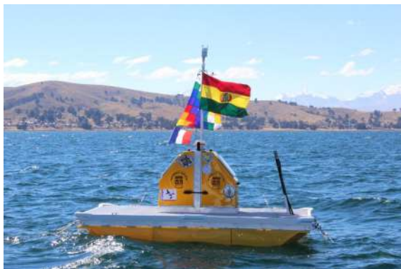
Figura 3-72 – Boya Hidro-Meteorológica, el día de su despliegue en el Lago Menor del Titicaca el 28 junio de 2019. La boya fue fabricada por XYLEM Inc., https://www.xylen.com/en-us/ . Comprende una plataforma de 3,6 x 2 metros, una estación meteorológica completa ultrasónica, un perfilador equipado de sonda multiparamétrica subacuática, dos dataloggers y un modem (Lazzaro 2019). Foto: J. Nuñez, despliegue el 28/06/2019.
