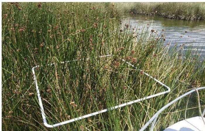
Figura 2-59 – Cuadrante de muestreo de 1m x 1m, fabricado en tubos de PVC.
