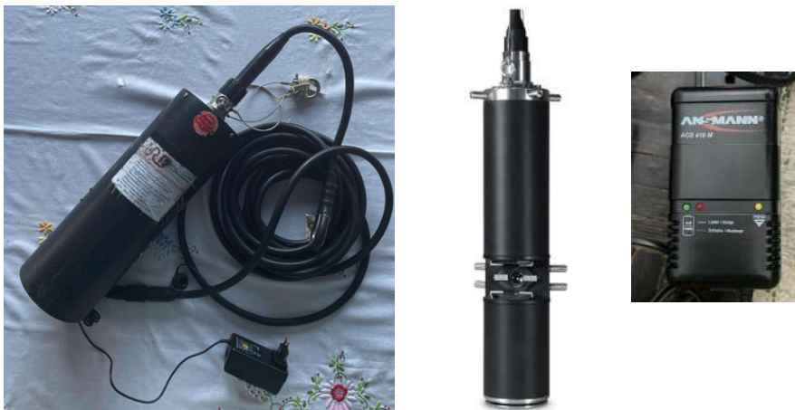
Figura 2-6 – A izquierda, sonda FluoroProbe bbe con cubierta protectora, conectada a su cable de alimentación y cargador. Este mismo cable conecta la sonda a la computadora. Al centro, sonda FluoroProbe bbe sin su cubierta, mostrando el compartimiento con los LEDs para la excitación y la recepción de la fluorescencia. A derecha, cargador conectado a la corriente. El LED rojo se ilumina para indicar que la sonda se está cargando. El LED verde se ilumina cuando la sonda está completamente cargada. Fuente: Moldaenke.
