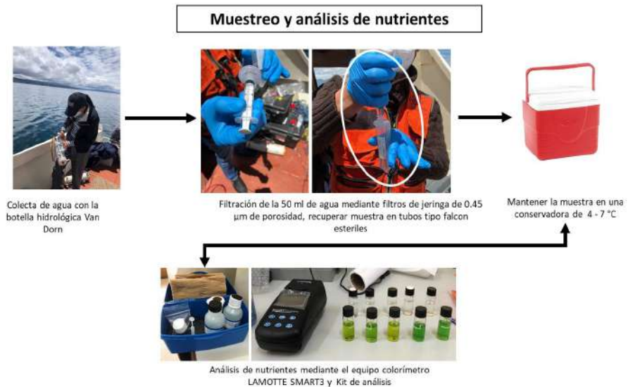
Figura 2-9 – Procedimientos para la colecta de muestras de agua y análisis de nutrientes.
