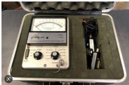
Figura 0-1 – El fluorímetro Turner y el quantámetro Li-COR con su unidad de medición. Los dos más sofisticados equipamientos analógicos que disponíamos en 1979-1980. Fuente: Fotos fabricantes
