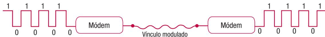
Los módems pueden ser internos (cuando están dentro de la caja de la PC) o externos (cuando forman un equipo independiente conectado a la PC –normalmente en el puerto serial– y a la línea telefónica o al conector del sistema central o su periférico y a la línea telefónica). En el caso de las computadoras portátiles, es común que los módems externos sean tarjetas que se instalan en los puertos específicos de la máquina. Cualquiera sea la forma del módem, cumple la función antes indicada.
